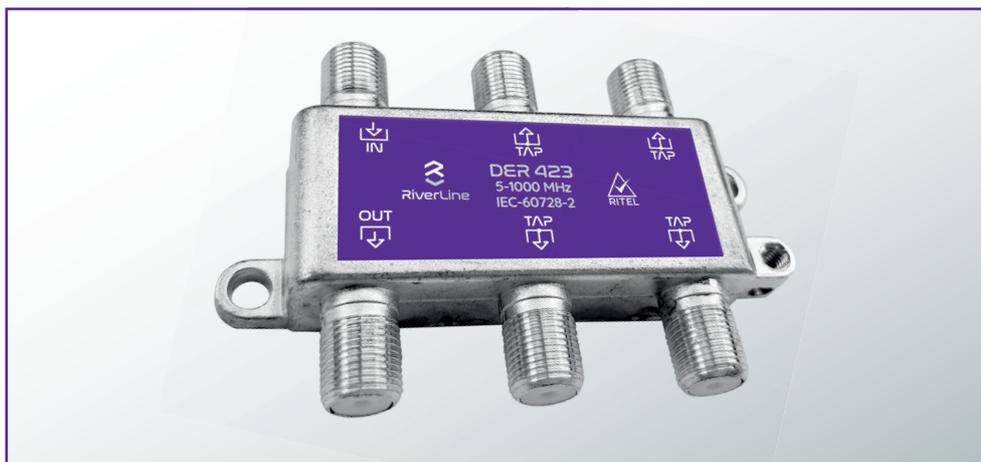
Los derivadores de 4 direcciones y 23 decibeles de pérdida a la derivación están pensados, diseñados y desarrollados para cumplir con los requerimientos del RITEL. Cuentan con una carcasa protectora en aleación de zinc con tratamiento superficial niquelado y su diseño de transmisión de dos vías es ideal para instalar en gabinetes de piso y cajas PAU.
