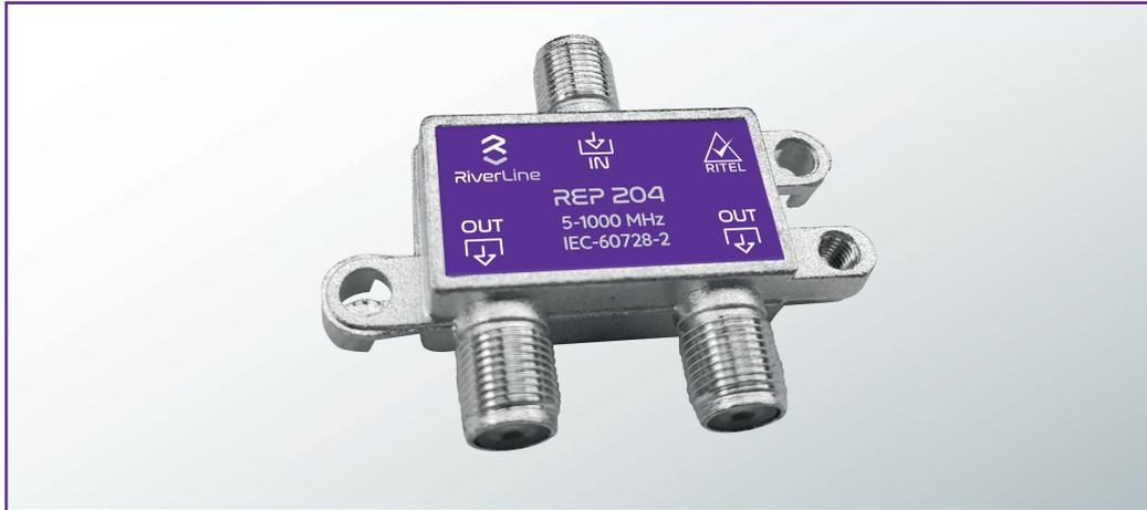
Los repartidores de 2 direcciones están pensados, diseñados y desarrollados para cumplir con los requerimientos de RITEL. Cuentan con una carcasa protectora en aleación de zinc con tratamiento superficial niquelado y su diseño de transmisión de dos vías es ideal para instalar en gabinetes de piso y cajas PAU.
