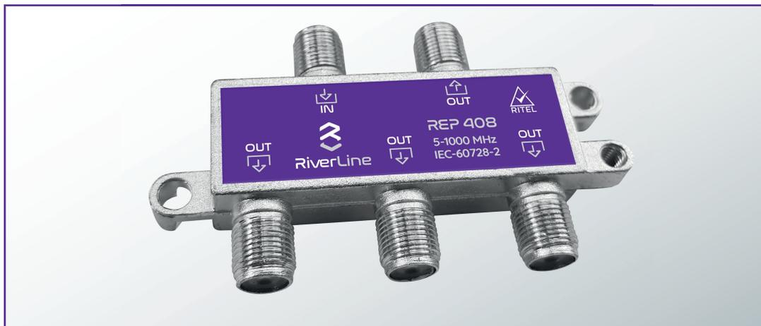
Los repartidores de 4 direcciones están pensados, diseñados y desarrollados para cumplir con los requerimientos de RITEL. Cuentan con una carcasa protectora en aleación de zinc con tratamiento superficial niquelado y su diseño de transmisión de dos vías es ideal para instalar en gabinetes de piso y cajas PAU.
